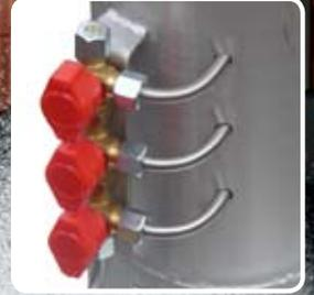
Durch die Steuerung der drei Ventile ist der Flammenaustritt beliebig kombinierbar!
